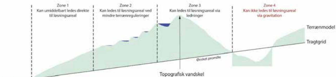
FIGUR 5 viser et principsnit for metoden i afledningspotentialeanalysen Zone 1+2 = kravleranalyse, Zone 3 = tragtanalyse.
