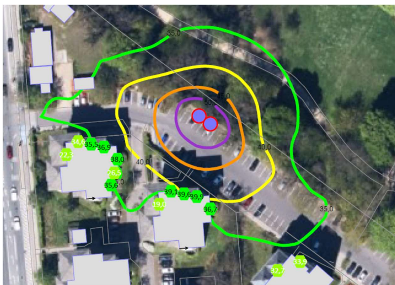
Figur; Eksempel på beregnet driftssituation. Beregninger viser, at det med 2 stk. 100 kW, 85 % driftstid, er muligt at overholde støjgrænser ved nærmeste bolig i nattetidsrummet (22-07).
